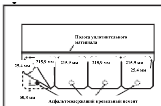
Рис. 5A Схема крепления для мансардной крыши или крутого ската
