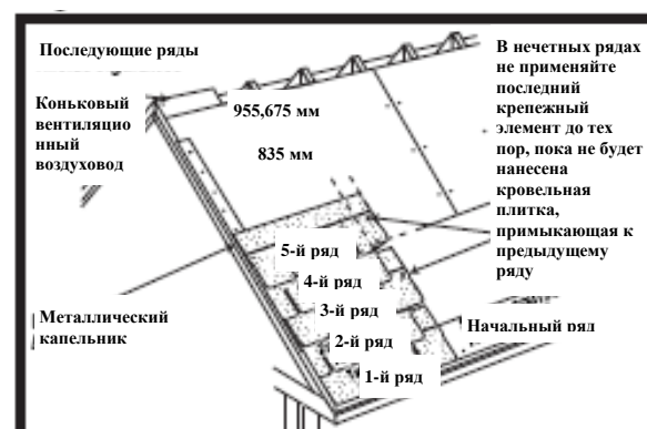
Рис. 6В Нанесение кровельных плиток
