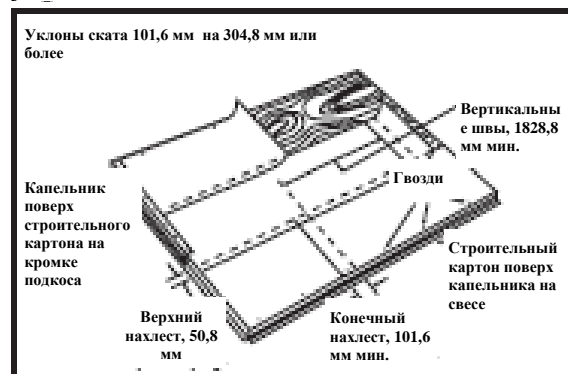
Рис. 2А Подстилающий слой при легком уклоне ската
