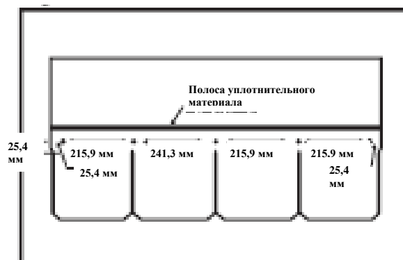
Рис. 5A Схема крепления для мансардной крыши или крутого ската
